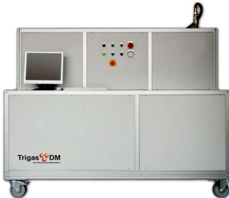
Das CVC-Kalibrierungssystem ist eine ideale und vielseitig einsetzbare Lösung für die Kalibrierung von Gasdurchflussmessern mit hoher Genauigkeit. Es bietet eine Kombination aus Leistung, Effizienz und Bedienkomfort. Computergesteuert und basierend auf dem Prinzip der kombinierten kritischen Düsen kalibriert es schnell und genau fast jeden Typ Gasdurchflussmesser.
