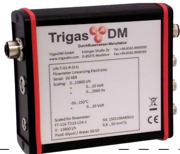
Die Geräte der TriLIN-Serie vereinen Linearisierung, UVC Temperaturkompensation, Signalkonditionierung sowie weitere Vorteile in einem Gerät – und sorgen somit für besondere Nutzerfreundlichkeit. Die benutzerfreundliche Programmiersoftware FlowHow+ ermöglicht die einfache Programmierung von Durchflusskalibrierungs- und Flüssigkeitseigenschaftsdaten sowie die Linearisierung und Skalierung von Durchfluss- und Temperatureausgängen.
